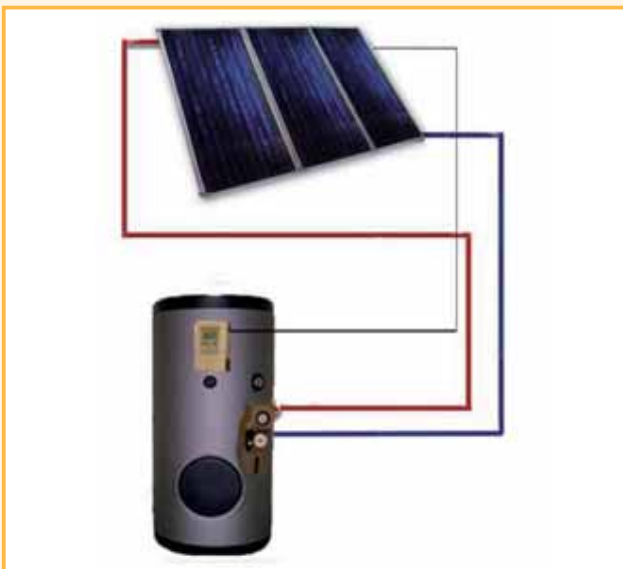
Esquema de modelos con grupo hidráulico integrado
