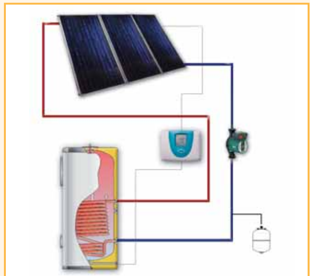
Esquema de modelos con grupo hidráulico por elementos
